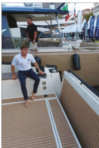
La plage de bain rétractable permet de clore le vaste cockpit, ou d'ouvrir l'arrière du bateau sur la grande bleue.
